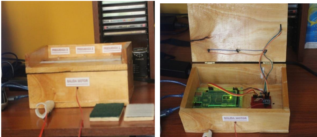
Figura 36. Chasis del sistema vibratorio.
