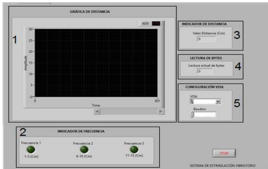
Figura 37. Pantalla principal o de control del sistema vibratorio.
