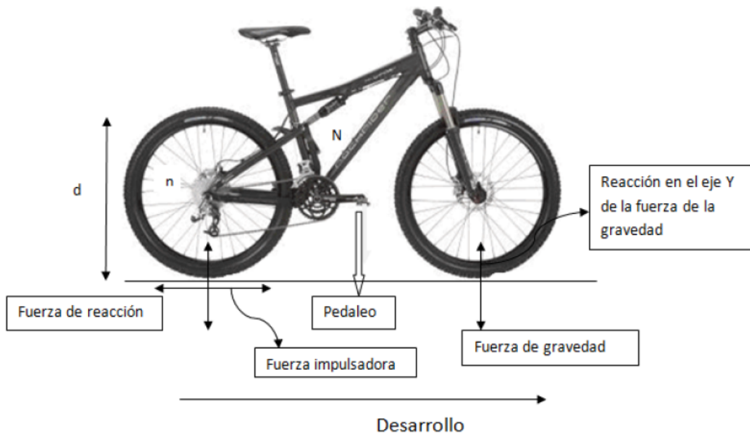
Figura 3.4: Fuerzas que actúan en una bicicleta. Fuente [2]
