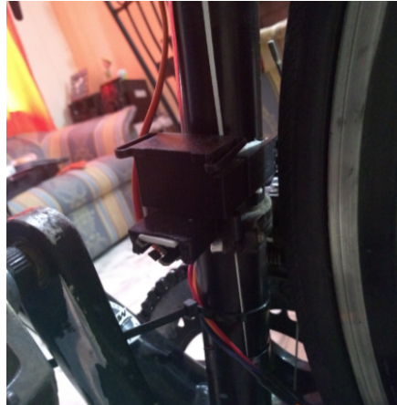
Figura 4.27: Posición sensor de efecto hall velocidad. Fuente propia.
