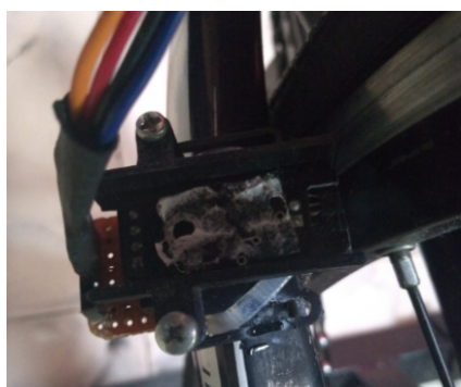
Figura 4.26: Posición sensor de efecto hall velocidad. Fuente propia.
