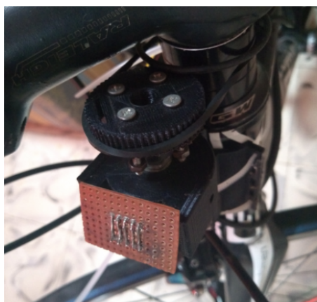
Figura 4.25: Posición del potenciómetro. Fuente propia.
