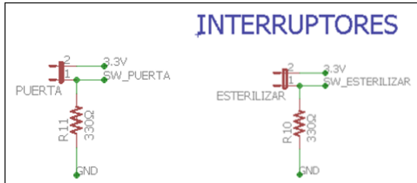
Ilustración 2.3.9. Diagrama eléctrico de la conexión de Interruptores en la fase de esterilización.
