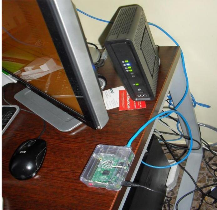
Figura 5. Raspberry Pi 3b+ enlazada con Router para ser utilizada desde computador por medio de lenguaje C. Fuente propia
