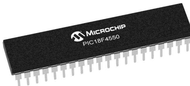
Figura 2.12 Microcontrolador de marca Microchip, referencia: 18F4550. Fuente [24]
