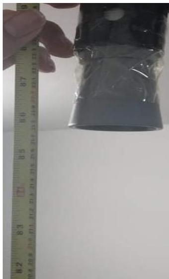
*Figura 5.1 Prueba de medición del sensor y comparación con una cinta métrica. Fuente propia*
