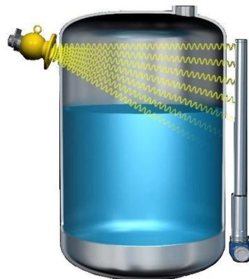
Figura 2.10 Sistema de medición de nivel por ondas de radiación con tubo receptor. Fuente [21]
