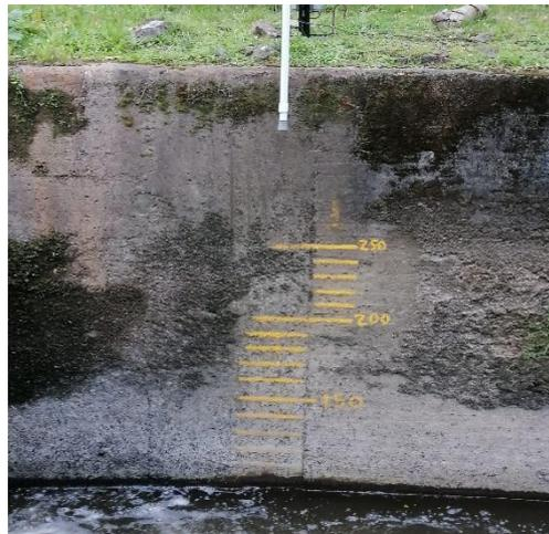
Figura 5.5. Sensor y mirilla en la bocatoma del Río Cauca. Fuente propia
