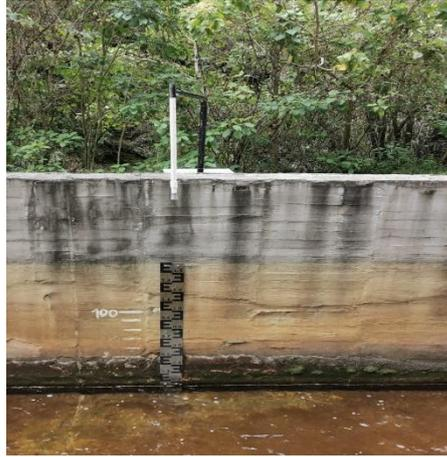
Figura 5.3. Sensor y mirilla en la bocatoma del Río Vinagre. Fuente propia
