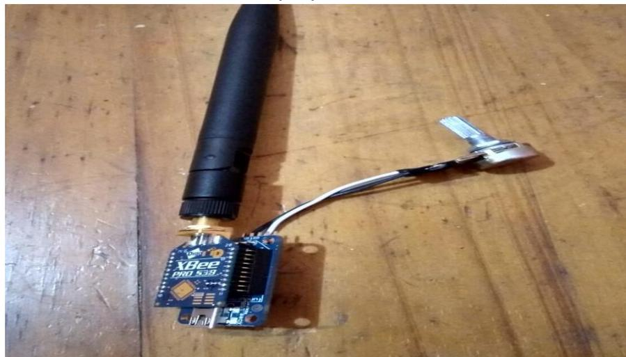
Figura 5. Tarjeta Xbee Con adaptación de Potenciómetro. Fuente propia
