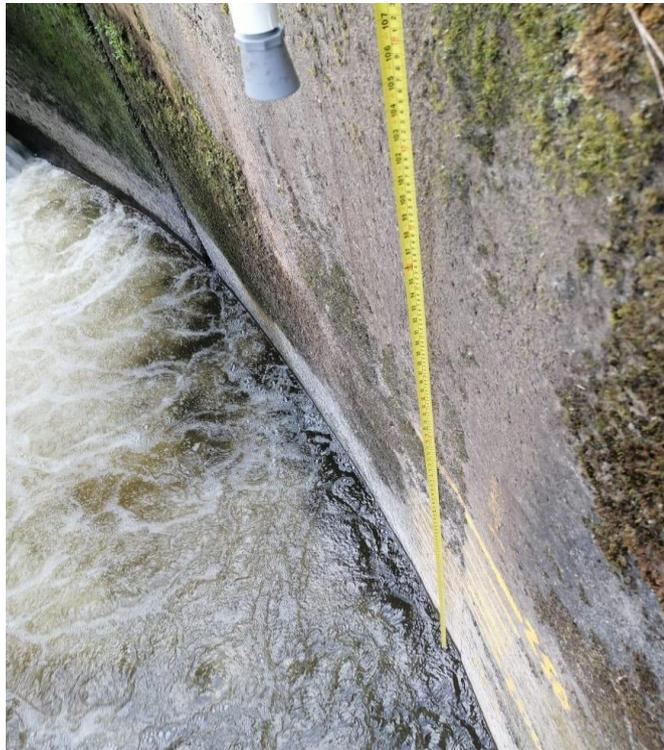
*Figura 5.10 Nivel del río Cauca observado bajo sensor y verificado por metro de medición Fuente Propia*
