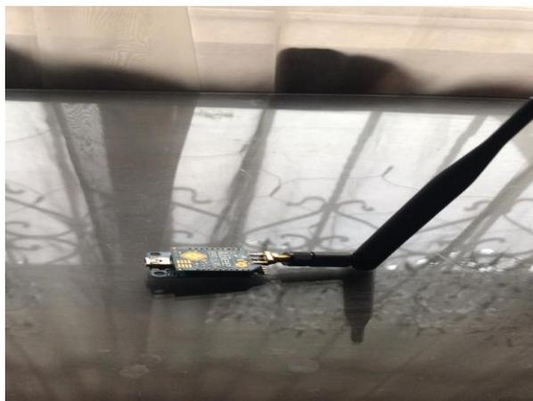
Figura 1. XBee ensamblada. Fuente propia
