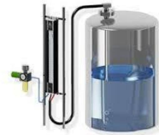
Figura 2.8 Sistema de medición de nivel por burbujeo. Fuente [18]
