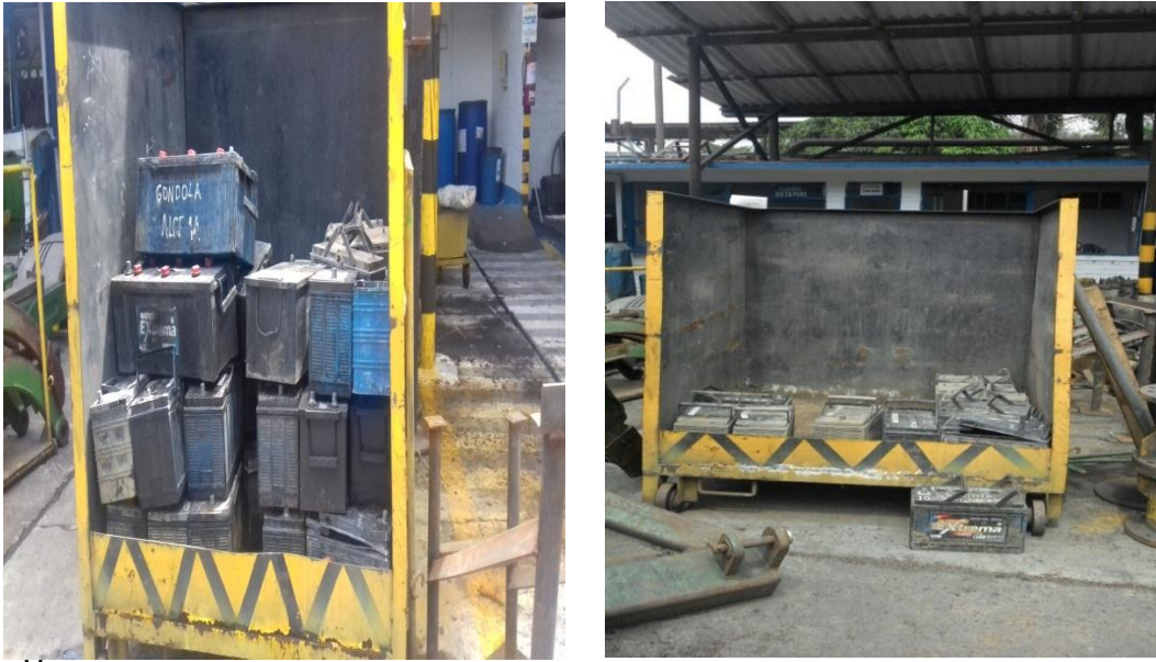
Imagen 1. Inspección Ambiental- almacenamiento Incorrecto de Residuos Peligrosos.
