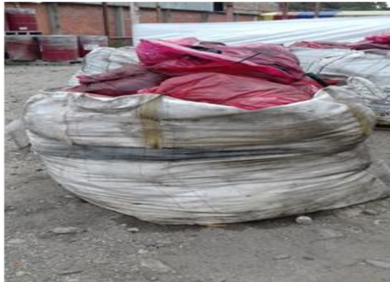
Imagen 9. Inspección ambiental- Almacenamiento incorrecto de residuos peligrosos.
