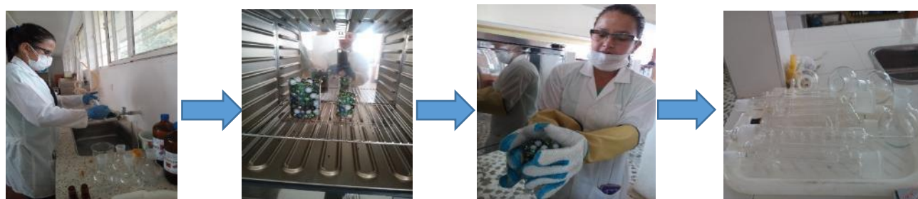
Lavado y secado de materiales para proceso de extracción soxhlet
