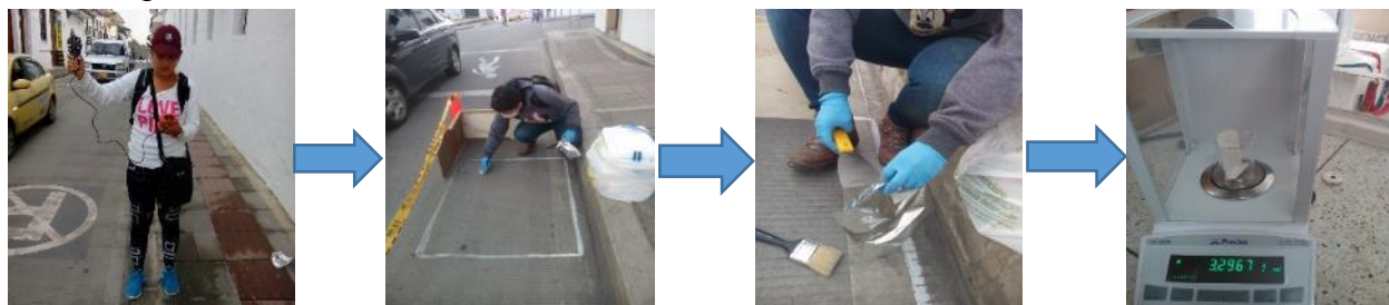
Proceso de medición de velocidad y dirección del viento, temperatura, toma de muestra y pesaje de la misma
