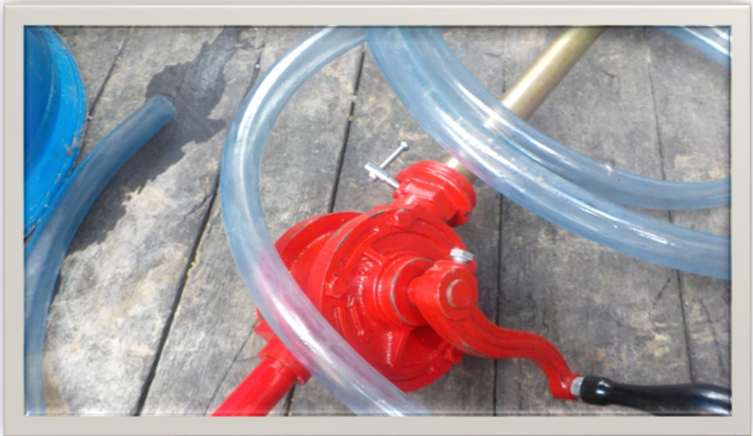
Fotografía 11. Bomba para el abastecimiento de combustible.
