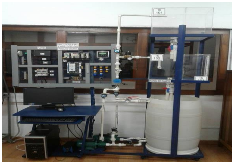
Figura 24 Banco de Pruebas de bombas centrífugas. Fuente: Autor
