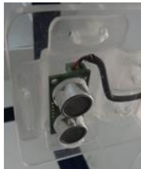
Figura 4 Sensor ultrasónico SRF06. Fuente: Autor
