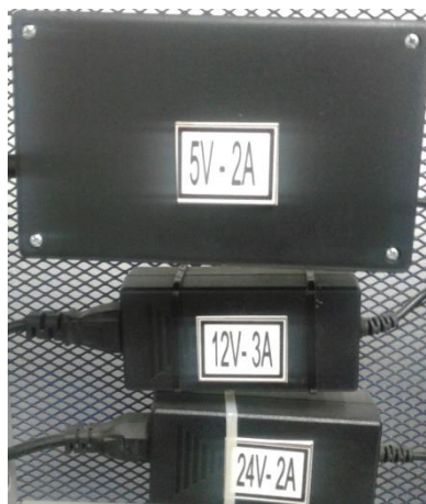
Figura 40 Fuentes de voltaje (De arriba hacia abajo 5VDC, 12VDC, 24VDC). Fuente: Autor
