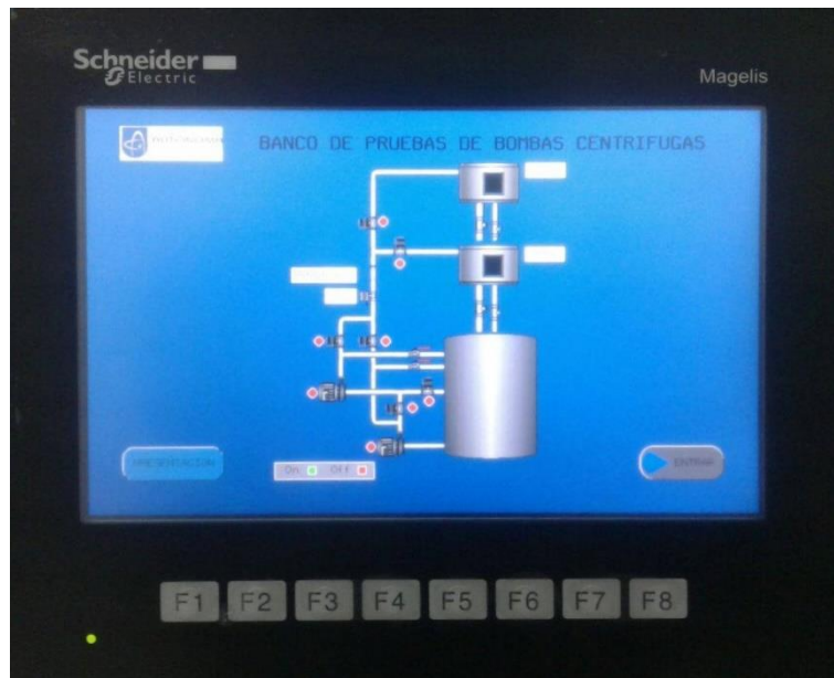
Figura 58 Visualización del programa funcionando en la pantalla HMIGTO3510. Fuente: Autor
