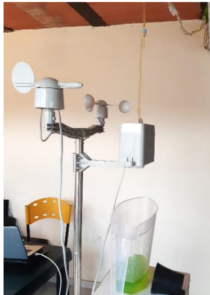
Figura 5.1.11 Montaje de prueba para la calibración del pluviómetro Fuente: Propia
