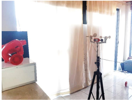
Figura 5.1.14 Montaje de prueba para la calibración del anemómetro Fuente: Propia
