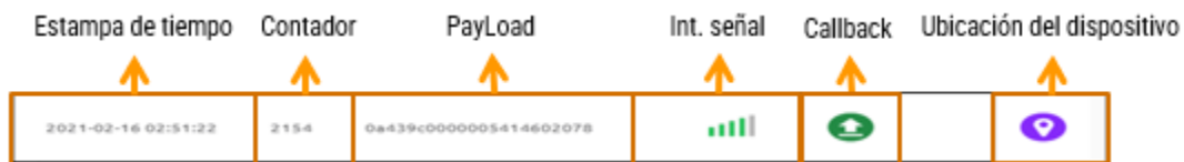
Figura 2.3.39 Trama completa enviada por el Maestro hacia el Sigfox Backend
