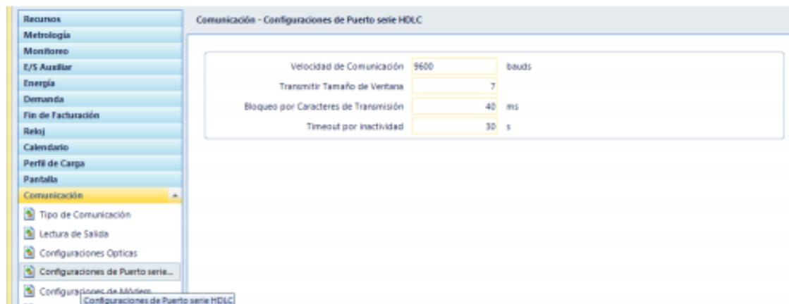
Figura 31 Configuración del puerto serie de ACE ITRON SL-7000. Fuente: Propia.
