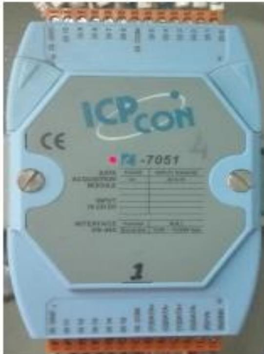
Figura 14 Modulo ICP CON 7051. Fuente: Propia.
