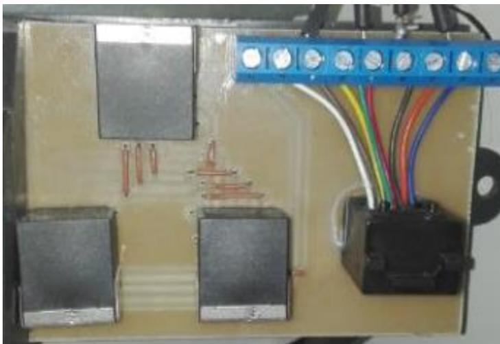
Figura 28 Tarjeta de conexión para bus de datos Full-Dúplex. Fuente: Propia.
