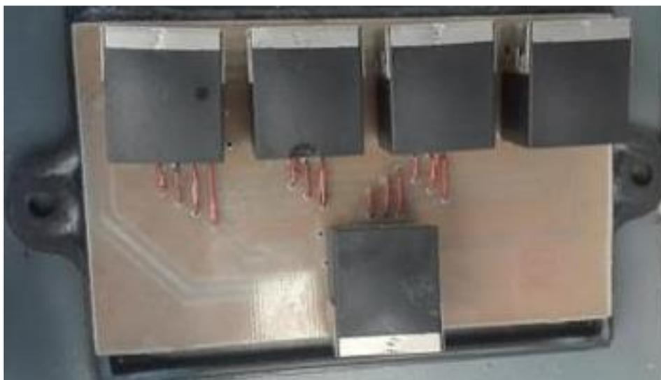
Figura 29 Tarjeta de conexión de nodo del bus de datos Full-Dúplex. Fuente: Propia.
