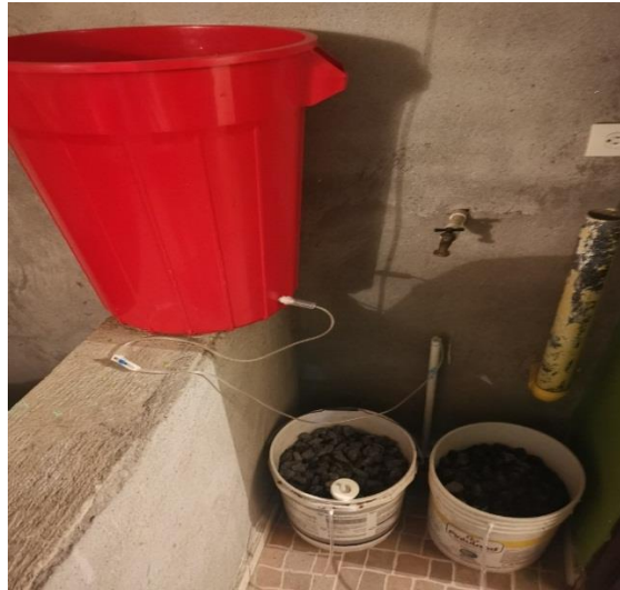
Figura 8. FAFAs en funcionamiento
