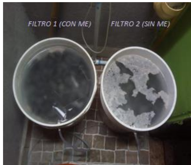
Figura 9. FAFAs con medio de soporte de grava (Filtro 1 con ME y filtro 2 sin ME)
