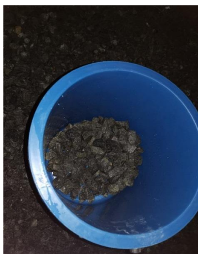
Figura 7. Grava utilizada como lecho filtrante
