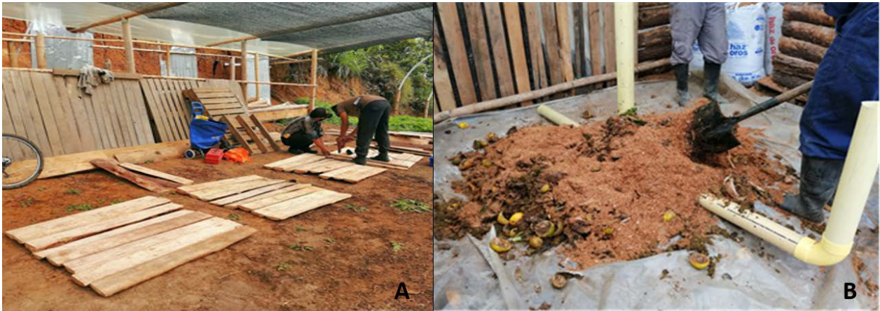
Figura 16. Instalaciones y adecuaciones, A: Sistema de Apilamientos Estático con Aireación Forzada (I); B: Sistema de Apilamiento Estático con Volteo Dinámico (II).
