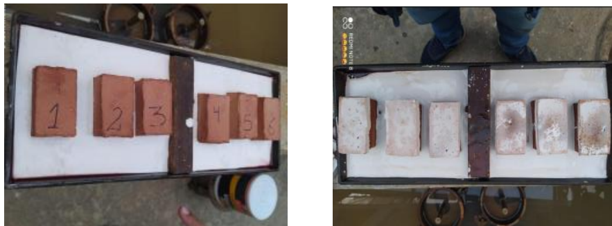
Figura 15. Proceso de recubrimiento de bloques de mampostería Fuente: Propia
