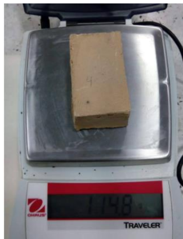
Figura 10. Pesado del bloque de mampostería húmedo preparado con mezcla No.1 lodo: arcilla Fuente: Propia
