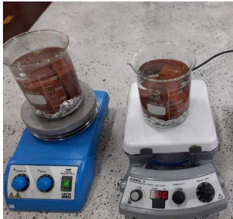
Figura 14. Prueba de absorción por ebullición de agua de los bloques de mampostería por 1 h a 100 °C Fuente: Propia
