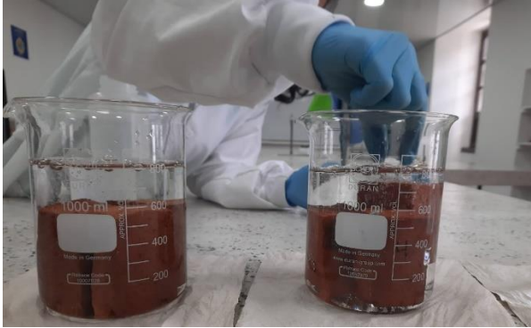
Figura 13. Prueba de absorción de agua de los bloques de mampostería por 24 h a 20 °C
