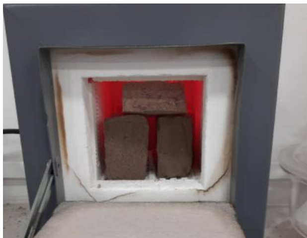
Figura 12. Cocción de los bloques de mampostería en la mufla Fuente: Propia
