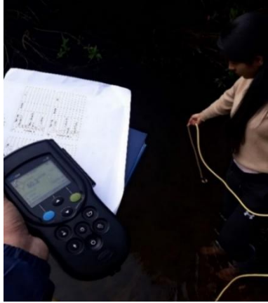
Imagen 1. Punto N°1 Humedal, toma de parámetros in situ por sonda multiparamétrica
