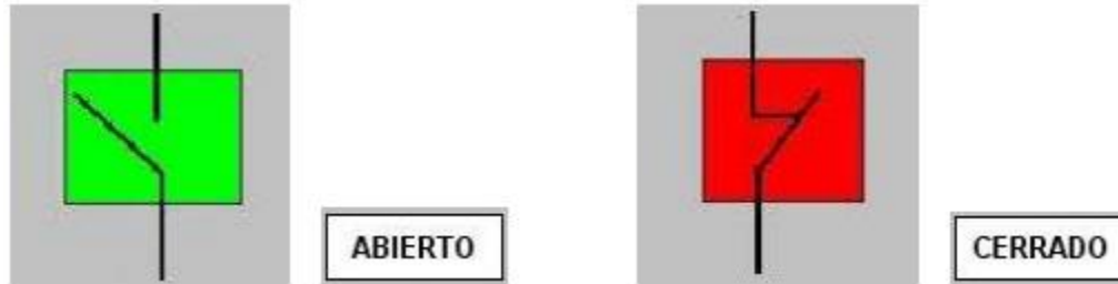
Ilustración 17. Estado del objeto dinámico en un interruptor. Fuente [23]
