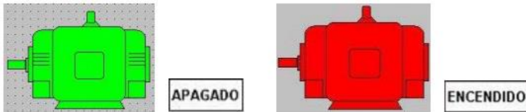
Ilustración 18. Estado del objeto dinámico en un motor. Fuente [23]
