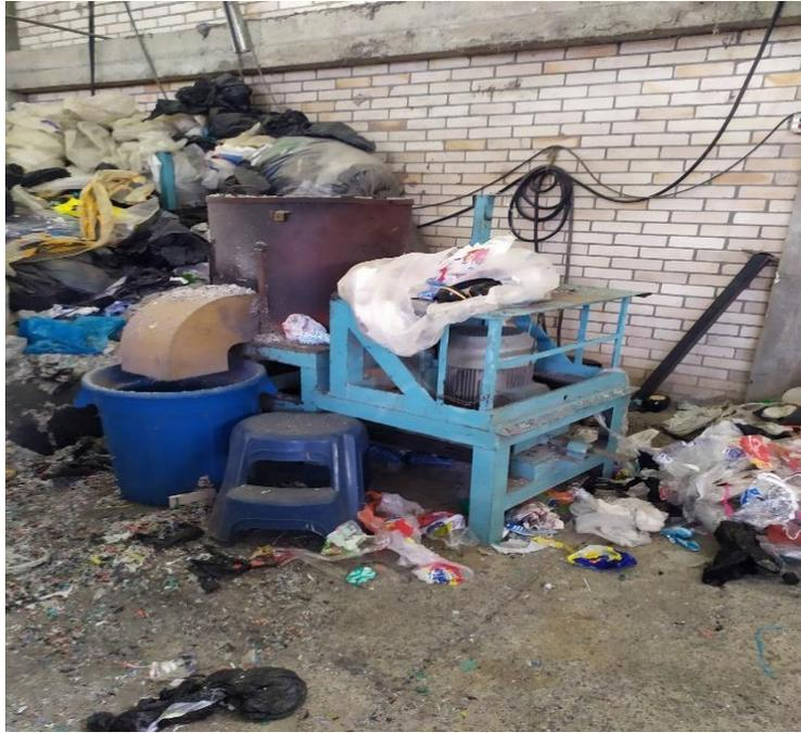
*Figura 24: Maquina Aglutinadora. Fuente: Registro fotogrfico visita tcnica en AREMARPO (2019.)*
