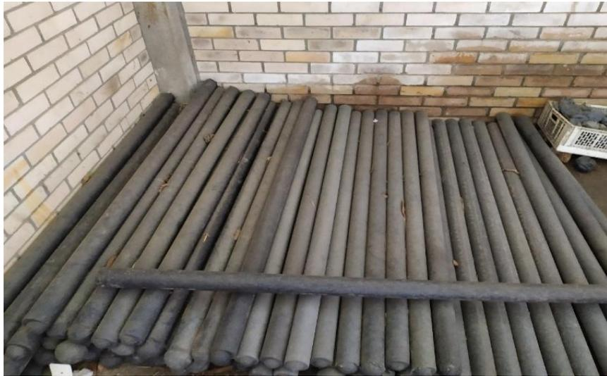
Figura 27: Postes y madera plástica. Fuente: Registro fotográfico visita técnica en AREMARPO (2019).
