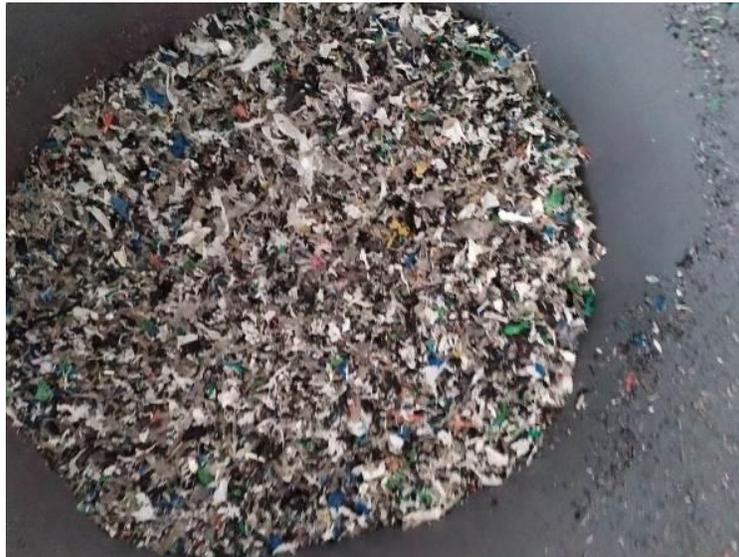
*Figura 25: Partículas de Plástico Triturado. Fuente: Registro fotográfico visita técnica en AREMARPO (2019).*
