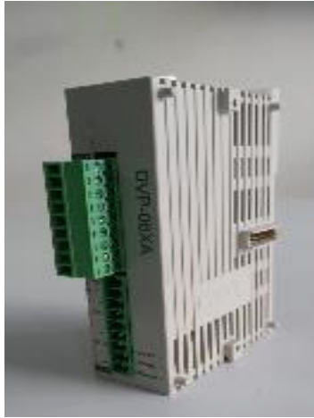
Figura 38. Módulo de expansión DVP-06XA Delta.
