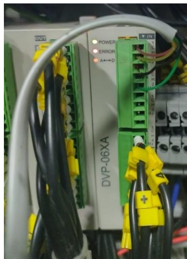
Figura 29. Conexión del encoder al módulo DVP-06XA.
