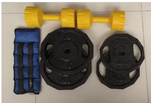
Figura 43. Pesos estándar para la caracterización del sensor.
