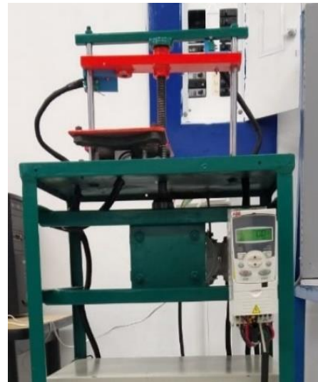
Figura 14b. Instalación del variador de frecuencia sobre la planta física.
