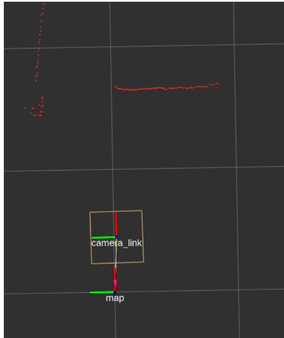
**Figura 11:** Representación de escáner láser virtual
