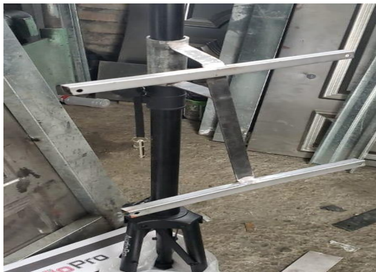
Figura 27 Trípode y estructura para panel solar (elaboración propia)
