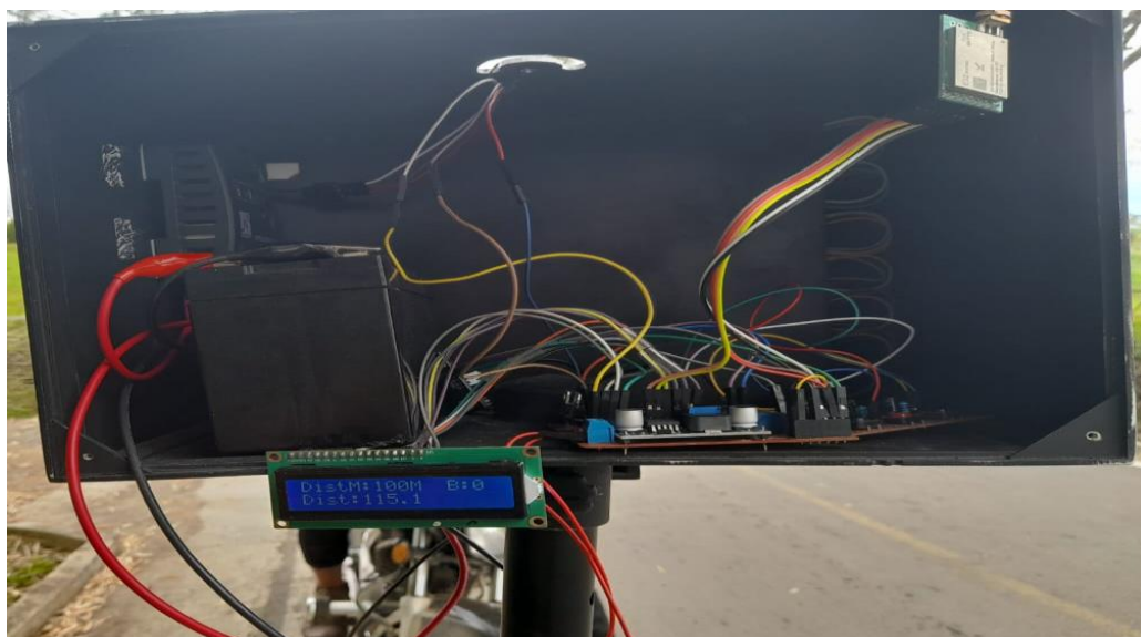
Figura 58. Prueba en ambiente controlado. Distancia medida (1.15 metros)
