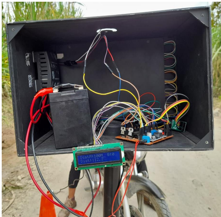
Figura 59. Prueba en ambiente controlado. Distancia medida (1.12 metros)
