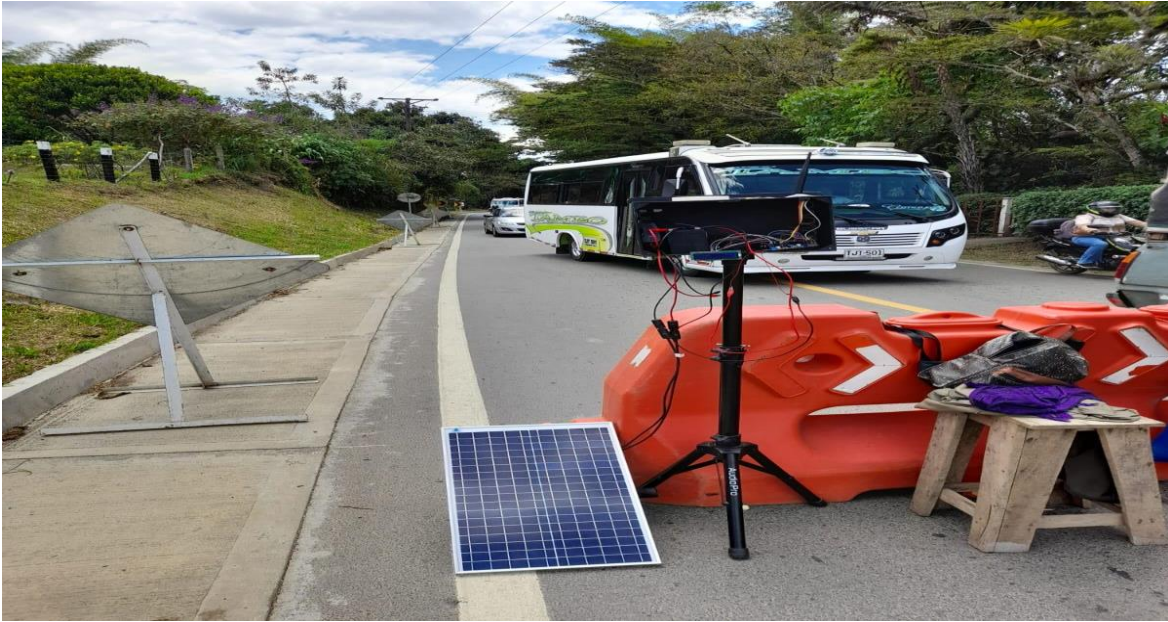
Figura 33. Funcionamiento del sistema solar en campo.
