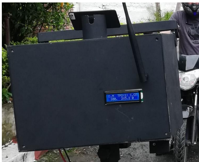
Figura 38 detección de automotores 1.04 metros sensor LM393 (elaboración propia)
