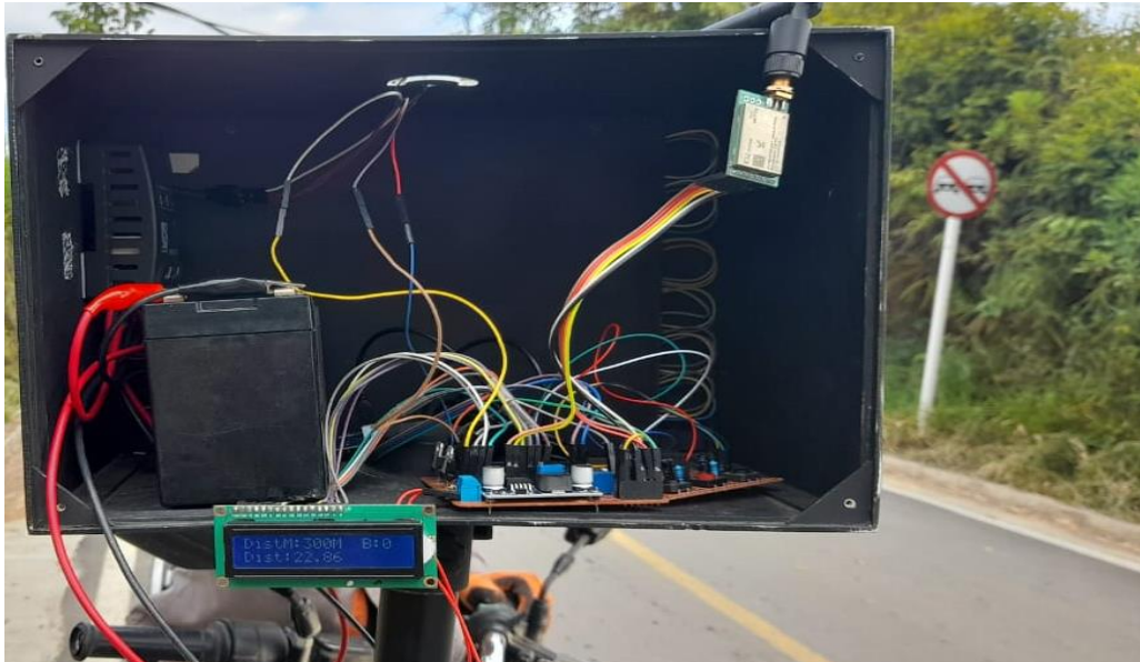
Figura 68. Prueba en ambiente controlado. Distancia medida (22.8 centímetros)
