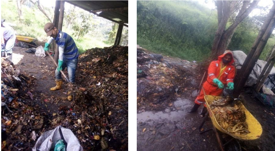
Figura 10. Volteo de la pila, proceso de compostaje
