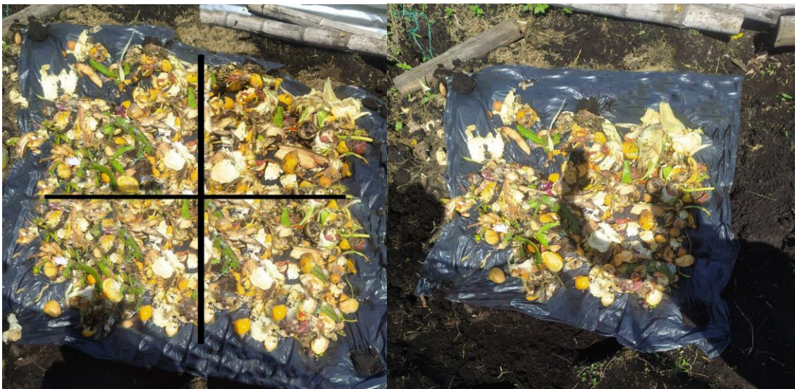
Figura 5. Caracterización de residuos método del cuarteo
