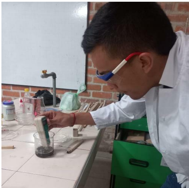
Figura 14. Medición de pH
