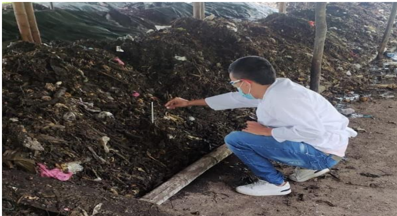
Figura 13. Toma de temperatura in situ
